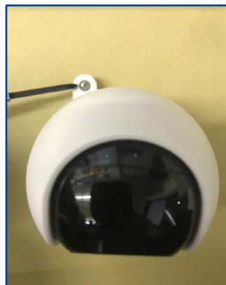
⑤カメラ本体を固定する ※④で取り外したビス
