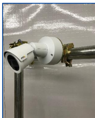
⑪完了 ※画角調整後はT10ビスを確実に締めてください。
