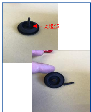
⑥付属のゴムブッシングの突起を取り外す。 ※円形部分を抑えながら突起部を引っ張ると取れます。
