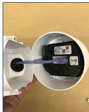
⑦LANケーブルをカメラ本体のLANポートに接続してカメラ本体とベースを閉じる ※カチッと音が鳴るまで差し込む
