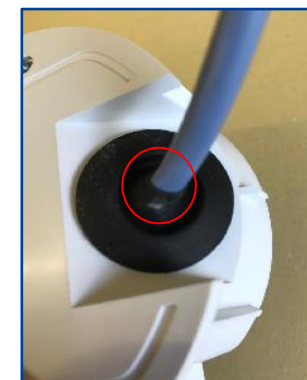
※防水性を確保するためにゴムブッシングの○印部分が外側に膨らむようにすること
