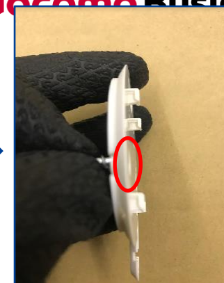
※ビスで固定した際に取付板からビスの頭が出ないものを使用してください。
