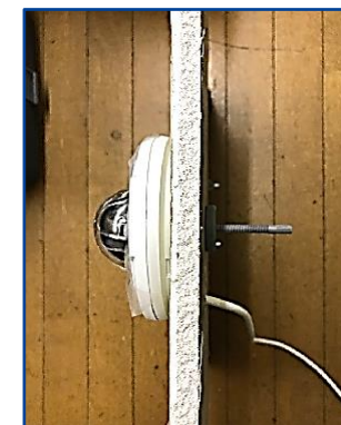
④カメラを固定具で固定する
