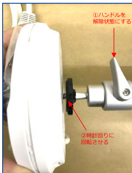
⑤フィクサーにカメラを固定する ※ハンドルを緩めてフィクサの黒色のネジをフィクサー側から見て時計回りに回転させる。
