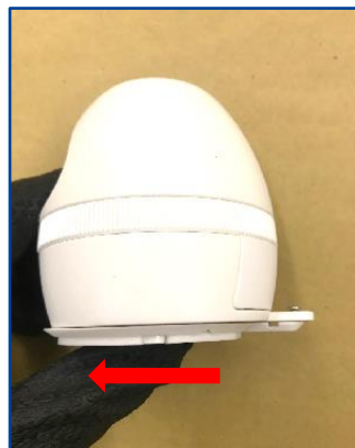
②取付板ををスライドさせて取り外す ※←方向にスライドさせて取り外す
