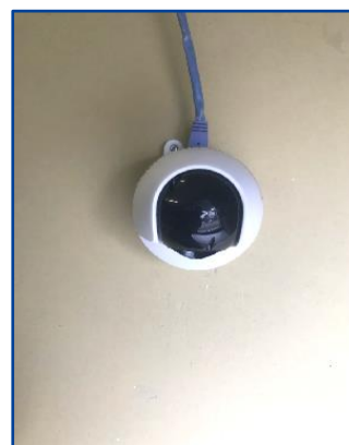
⑦LAN(UTP)ケーブルを接続する ※PoE SWもしくはインジェクター使用
