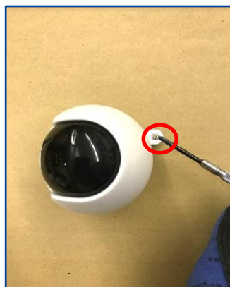
①カメラ本体と取付板を固定しているビスを#1プラスドライバーを用いて外す ※ビスの紛失に注意
