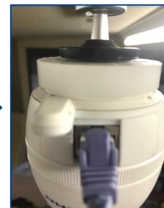
⑧LAN(UTP)ケーブルを接続する
