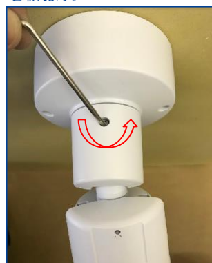
⑫保護フィルムを剥がして画角調整をする。 ※画像を確認しながら調整してください。
