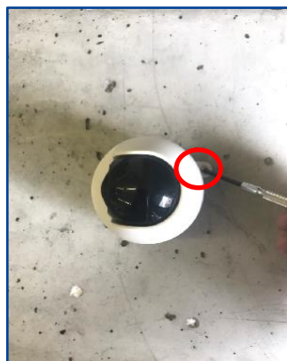
①カメラ本体と取付板を固定しているビスを#1プラスドライバーを用いて外す ※ビスの紛失に注意
