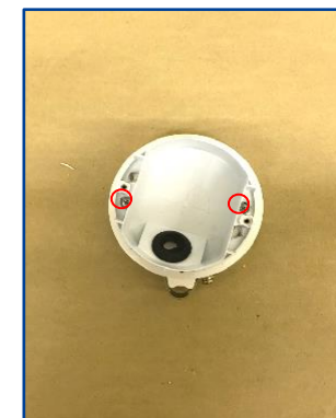
④ベースとビームラックを固定する ※M4x20mmタッピングビスを使用し○印2か所を固定する
