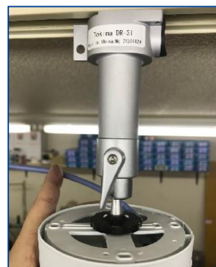
⑥フィクサーにカメラを取り付ける。
