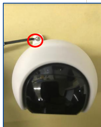
⑥カメラ本体と取付板を固定する ※①で取り外したビス
