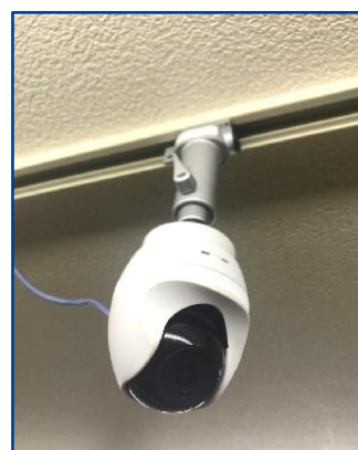
⑨画角を調整して完了 ※画角調整は映像を見ながら実施してください。
