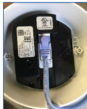
⑧LANケーブルを本体のLANポートに接続する ※カチッと音が鳴るまで差し込む
