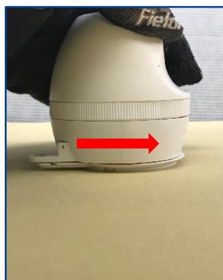
⑤カメラを取付板に固定する ※→方向にスライドさせて取り付ける
