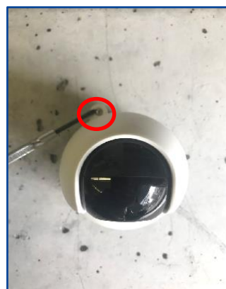
⑦カメラ本体と取付板を固定する ※①で取り外したビス
