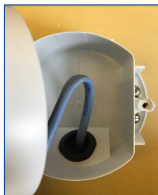
⑪ゴムブッシングを取付後にカメラ本体をベースに取り付ける ※T10ビス2か所
