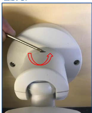
⑨保護フィルムを剥がして画角調整をする。 ※画像を確認しながら調整してください。 ※反時計回りで緩める。時計回りで締める
