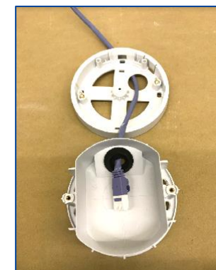
④LANケーブルをコンジットバックボックスとベースに通した後に2つを固定する。
