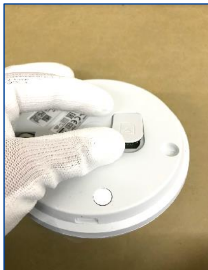
①カメラ背面のSDカード(任意)スロットの蓋を開けてSDカード(任意)を挿入する
