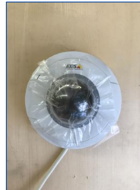
③カメラを取付金物に固定し画角を調整して完了 ※設置後は保護フィルムを剥がしてください ※画角調整は画像を確認しながら実施してください。
