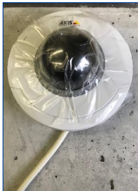
⑤カメラを取付金物に固定して完了 ※フィルムを剥がして画像を確認しながら画角を調整してください。
