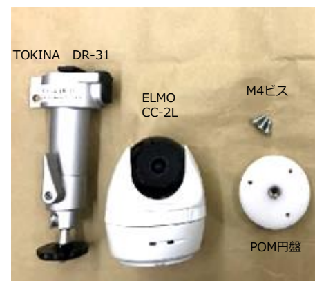
⑥カメラをダクトレールフィクサーに 固定する ※黒色ネジを回して固定
