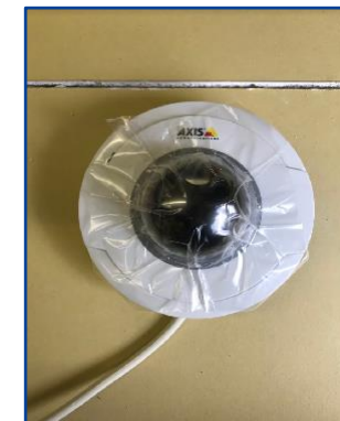
⑤カメラを取付金物に固定して完了 ※フィルムを剥がして画像を確認しながら画角を調整してください。
