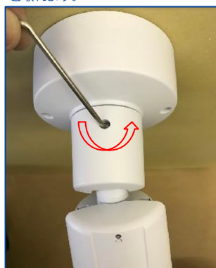
⑫保護フィルムを剥がして画角調整をする。 ※画像を確認しながら調整してください。 ※反時計回りで緩める。時計回りで締める
