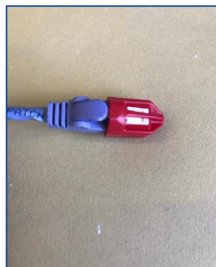
⑦付属の保護キャップをRJ45プラグに被せる
