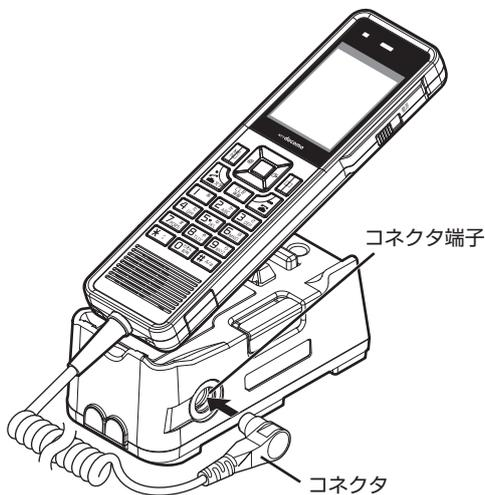
1 衛星ハンドセットのコネクタを図の向きでコネクタ端子へ水平に差し込む
