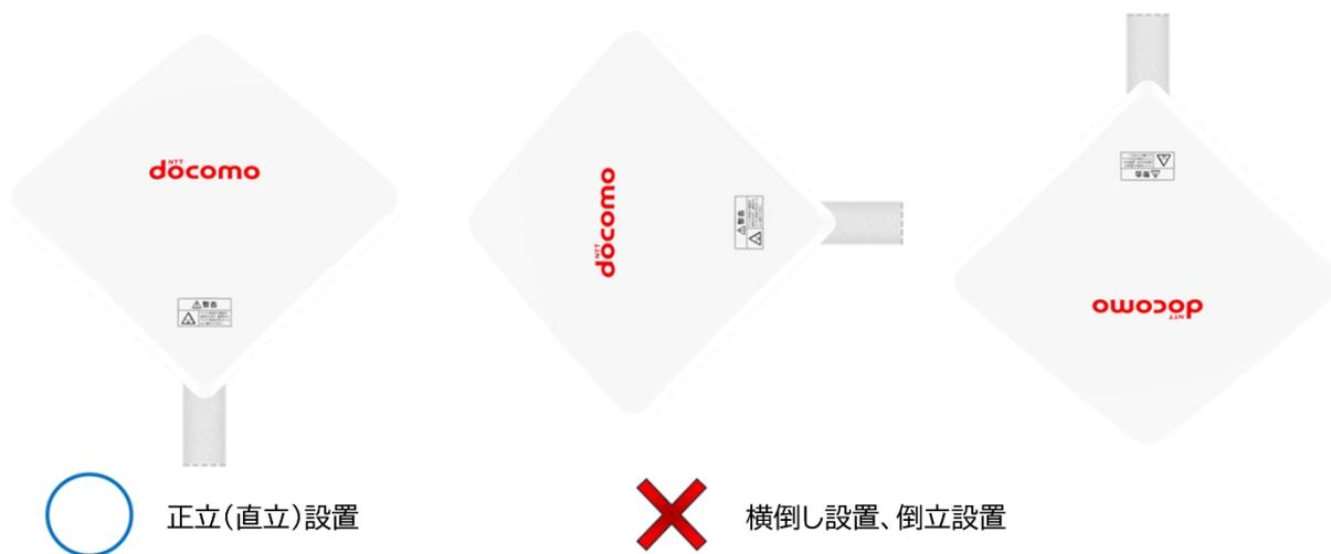
図 11 屋外設置アンテナの取付け向き
