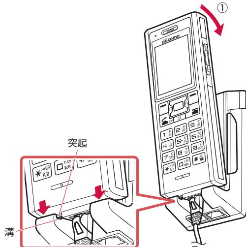
ハンドセット置台と衛星端末、ハンドセットとハンドセット置台を下図のように接続して、衛星端末からより離れた場所でハンドセットを使用することもできます。
