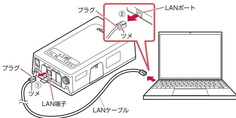
**1** 衛星端末側のLANケーブルのプラグのツメを押さえながら引き抜き、LAN端子カバーを閉じる(①)
